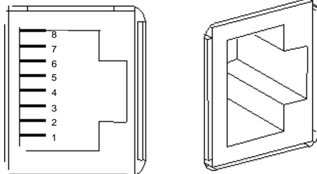
**Note :** Le brochage est conforme au standard Schneider.
