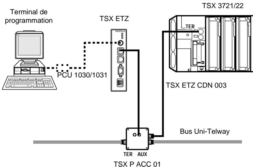
Cette configuration est recommandée, car elle laisse disponible la prise TER du module TSX ETZ pour y connecter un terminal, par exemple.
