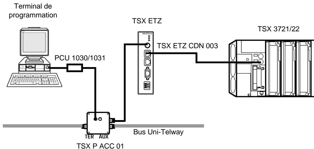
**Note :** Il n'est pas possible de connecter un terminal de réglage FTX 117 sur la prise TER du module TSX ETZ. La consommation du terminal sur la prise TER est trop importante.
