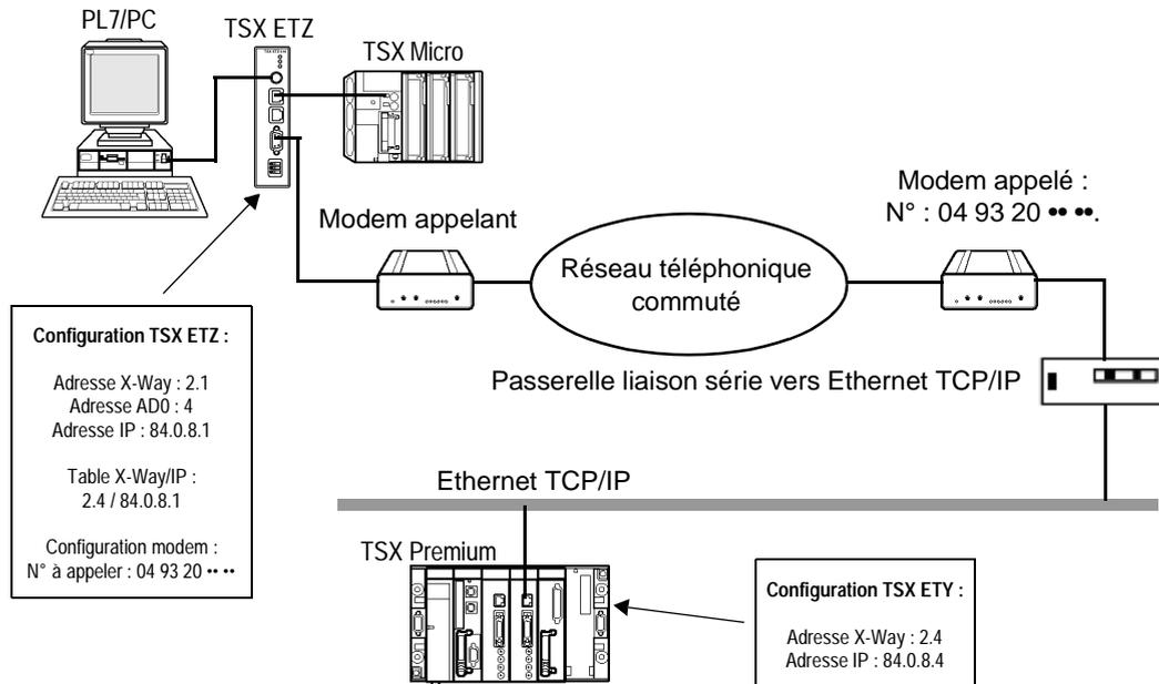
**Exemple de programmation d'un TSX Micro client**
