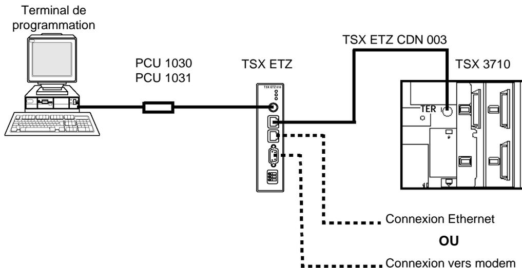
**Connexion sur prise AUX** Exemple de connexion d'un TSX ETZ sur la prise AUX d'un TSX 3721/22 :
