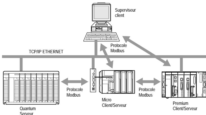
Un même TSX ETZ peut communiquer avec un équipement distant en mode client (par exemple un automate Quantum) et un autre équipement distant en mode serveur (par exemple un PC Superviseur).
