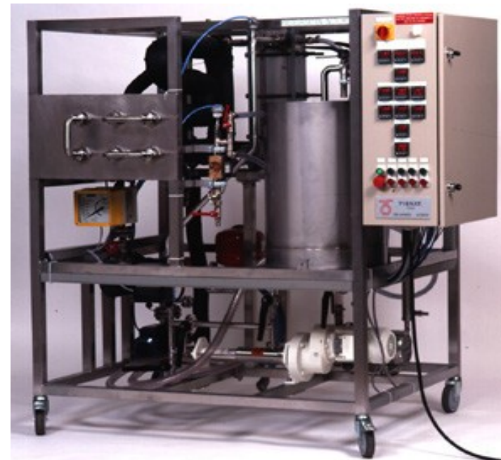
Conduite de pasteurisation
